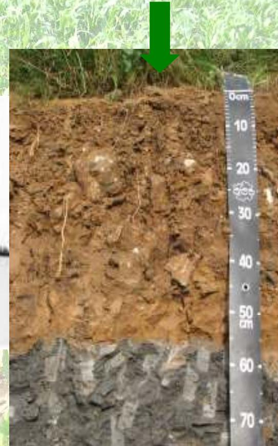
Les diagnostics agro-pédologiques ont pour objectif la vérification de leur conformité vis-à-vis du Cahier des Charges Techniques (CCT), à savoir **20 cm** de Terre Végétale (TV) + **30cm** d'une Sous Couche de matériau pédologique (SC) posée sur un **Remblai**, l'ensemble devant conserver des propriétés permettant une future occupation agricole ou forestière.
