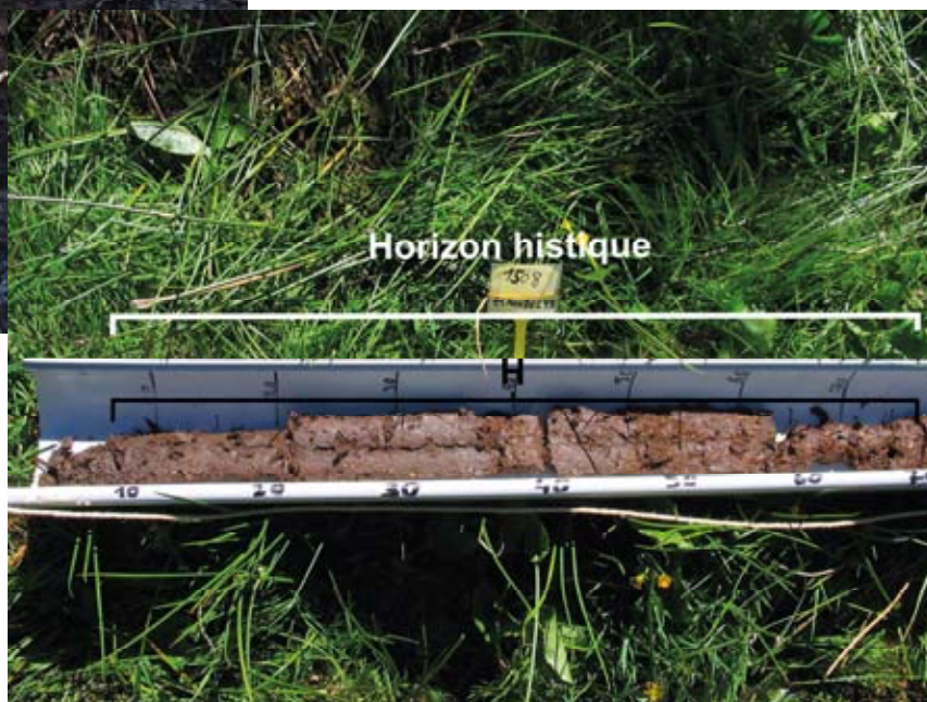
Photo 5bis : Sondage présentant un horizon histique (© Ensaf)
