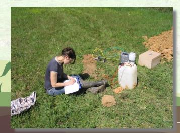
Exemple de couplage de mesure de perméabilité avec observations & mesures des sols sur profils
