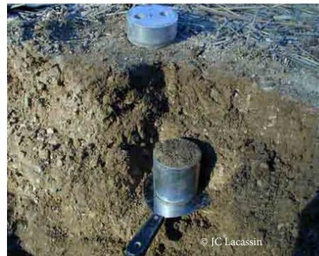
La teneur en eau du sol peut être mesurée en faisant la différence entre la masse humide et la masse sèche d'un volume de terre connu prélevé à l'aide d'un cylindre
